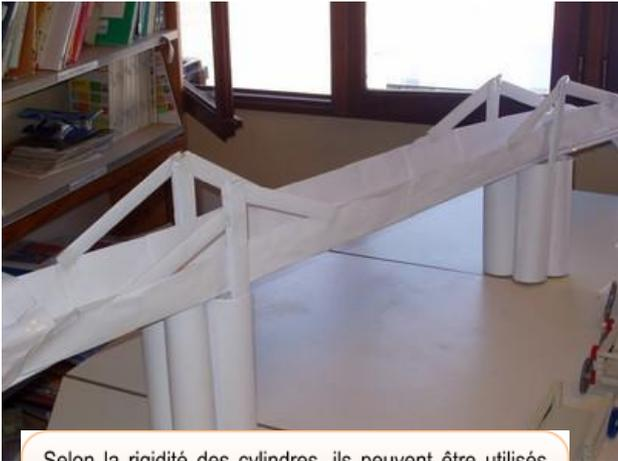
Selon la rigidité des cylindres, ils peuvent être utilisés comme poutres principales ou être pliés en forme de triangles ou de carrés avec des diagonales.
